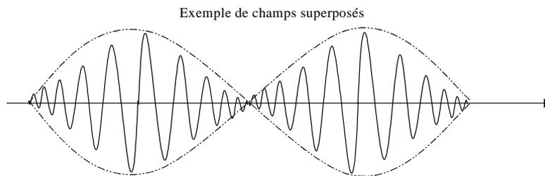
C'est une onde plane non monochromatique. L'amplitude se propage à la vitesse  $\frac{\Delta\omega}{\Delta k} = c$
